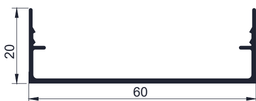
Código AW 5378 - Tapa columna simple 0,331 Kg/m - Largo 6,03- Tiras por paquete 6 und.
