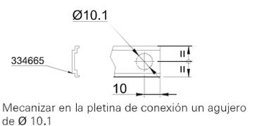
Mecanizar en la pletina de conexión un agujero de Ø 10.1
