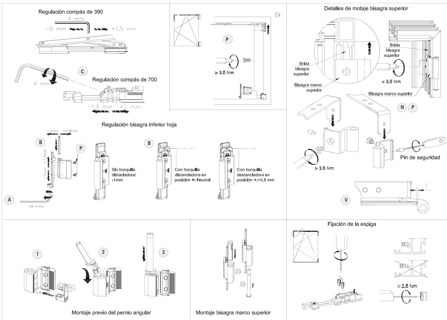
Todos los taladros de pletina son de  $\varnothing$  10 mm. Las partes móviles deben ser tratadas antes del montaje con grasa libre de ácidos, especialmente el eje de pernio angular, la pieza insertada del pernio angular, el pasador de soporte de compás, el canal de pletina y los bulones de cierre. Todos los puntos de cierre se pueden ajustar con una llave Allen. ( $\pm$ 1mm). Para lista de las plantillas de montaje, ver CTL\_14 (Catálogo Roto AluVision)
